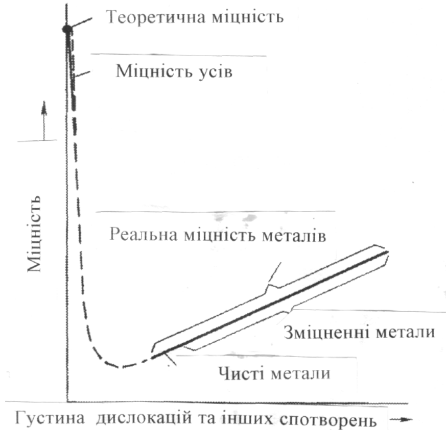
Рис.3. Міцність кристала у залежності від спотворень кристалічної решітки (схема за І.О.Одингом та А.А.Бочваром).
