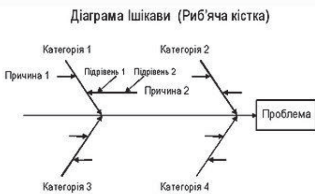
Рис. 3. Схема причинно-наслідкової діаграми Каору Ісікави, яка унаочнює роботу над покращенням якості виробничих процесів.
